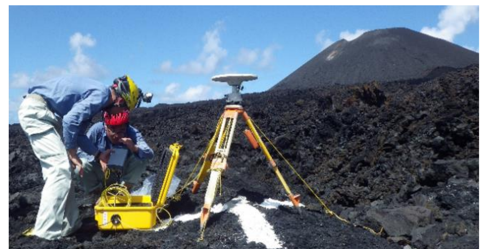
三等三角点「西之島南」におけるGNSS測量
